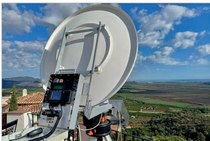
4. Detalle del equipo multibanda para 13, 6, 3 y 1,5 cm. Foto F5BUU
